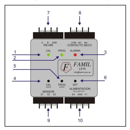
**1-Indicador luminoso – Modo Calibración de sensor:** Cuando se presiona el pulsador "CAL" [4] se ingresa al modo Calibración y se enciende el indicador luminoso. Este modo sirve para ajustar el sensor con su unidad L-510. Este proceso solo es necesario cuando adquiera un nuevo sensor o se compren ambas partes por separado.
